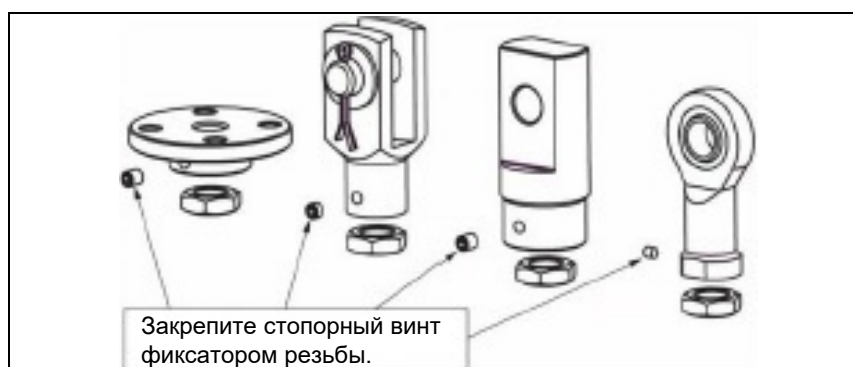
Рис. 7: После регулировки положения зафиксируйте фланец, вилку, поворотный подшипник или головку с шаровым шарниром.
