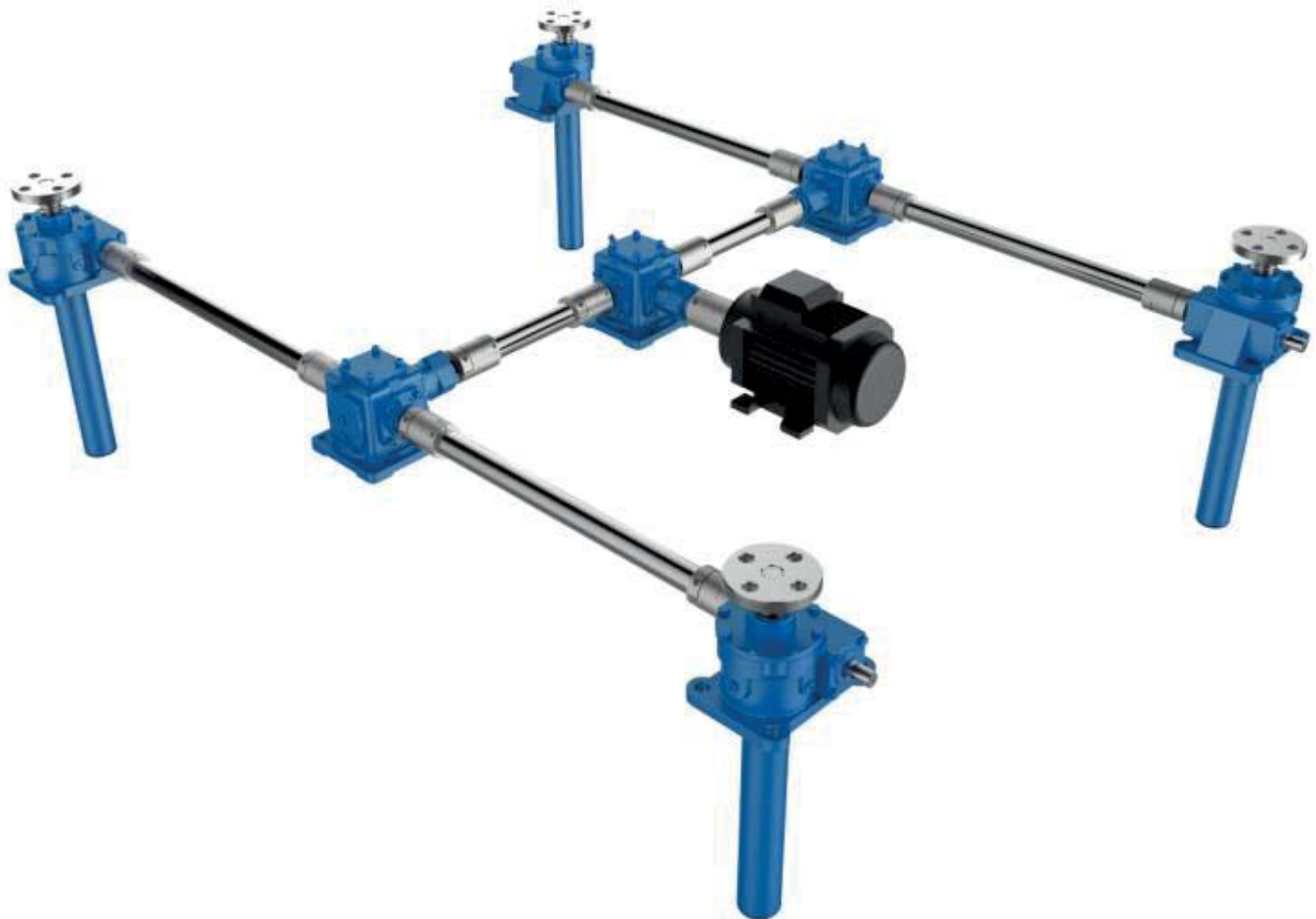
Тип "H" - Система из четырех домкратов 4 червячных винтовых домкрата + 3 спиральных конических редуктора + 1 двигатель + 6 соединительных валов + 13 муфт
