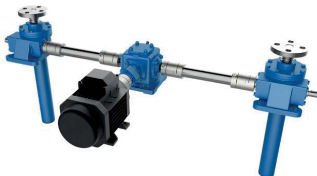
Тип "T" - Система из двух домкратов 1 двигатель + 2 червячных винтовых домкрата + 1 спиральный конический редуктор + 4 муфты + 2 соединительных вала
