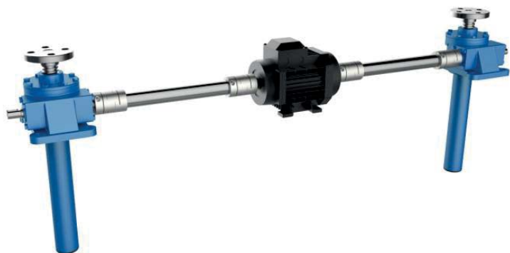
Тип "I" - Система из двух домкратов 1 двигатель + 2 червячных винтовых домкрата + 4 муфты + 2 соединительных вала
