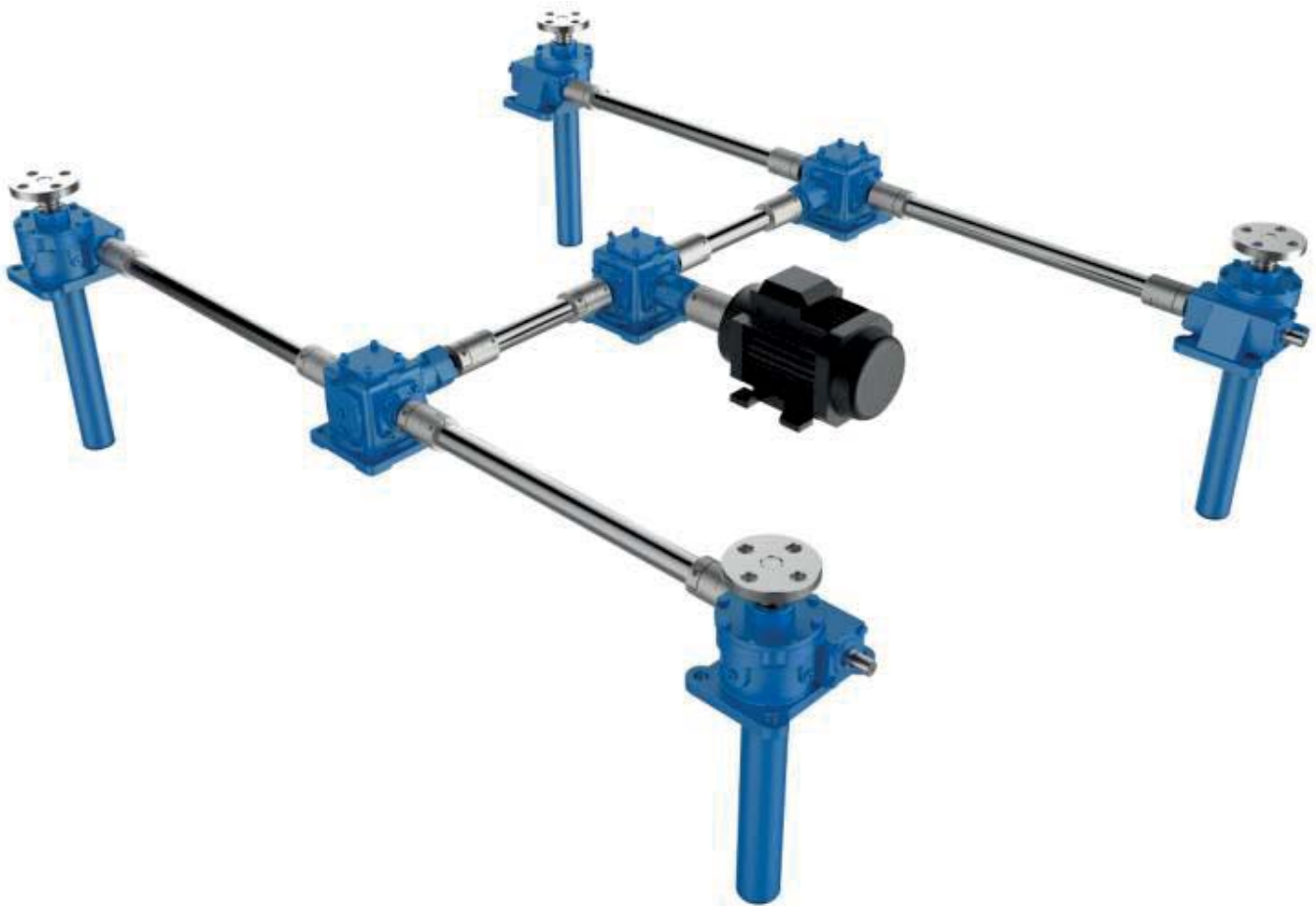
Тип "Н" - Система из четырех домкратов 4 червячных винтовых домкрата + 3 спиральных конических редуктора + 1 двигатель + 6 соединительных валов + 13 муфт
